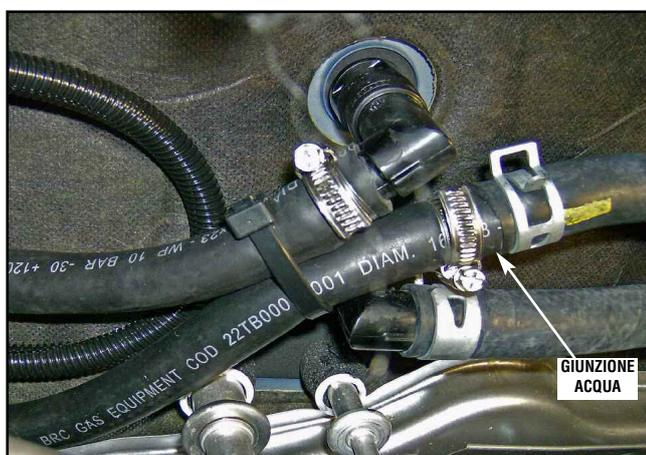
Realizzare il circuito acqua del riduttore interrompendo quello originale della vettura, utilizzando un raccordo dritto, come mostrato in figura.
