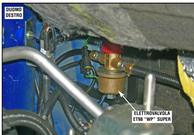
Collegare in ingresso ed in uscita dell'elettrovalvola la tubazione rame. Bloccare sulla staffa l'elettrovalvola e fissare quest'ultima alla vettura (duomo destro e paratia motore).
