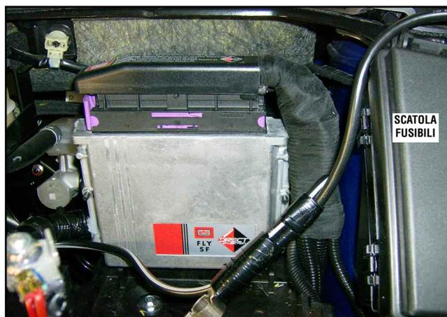
Installare la centralina Sequent Direct Injection nella scatola di alloggiamento della batteria, vicina a quella dei fusibili.
