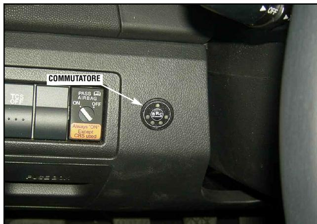
Installare il commutatore a destra del comando per la disattivazione dell'airbag lato passeggero, come mostrato in figura.
