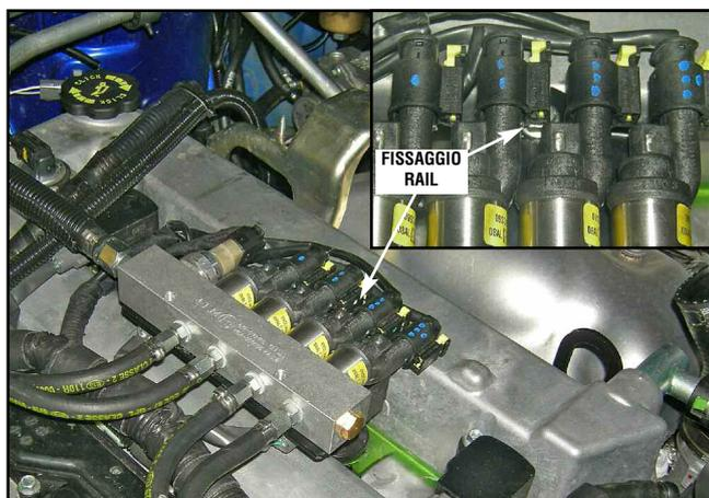
Avvitare sul rail gli iniettori BRC ed il sensore. Fissare il rail e la staffa alla vettura come da figura. Raccordare le tubazioni ugelli su ogni iniettore. Collegare la tubazione proveniente dal filtro sull'ingresso rail.
